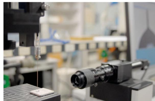
Apparecchiatura per misura angolo di contatto
